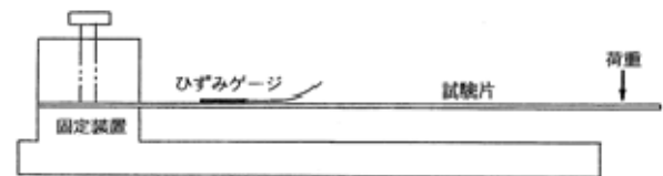
図 1 静ひずみ測定の試験装置
